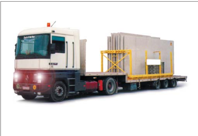
Bild 16: Tiefbettsattel mit beladener Transportbox
